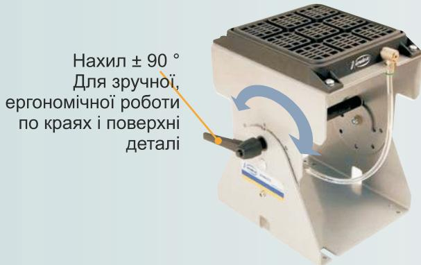
Допоміжна система кріплення SVN470 складається з базової системи SVN250, встановленої на опорі з можливістю нахилу. Дозволяє обробляти краї і поверхню деталі, не змінюючи фіксації. До комплекту постачання входить також струбцина для швидкого кріплення системи SVN460 до робочого столу і набір з трьох гумових ущільнювачів різних периметрів. Опціонально можна замовити комплект з чотирьох гвинтів для встановлення SVN250 на базі (0999102).
